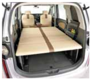
フルフラットなスペースは、2名乗車時には大型のスポーツギア等を、ボードのヒンジ部を利用してルーフ等で固定し、効果的に積載できる。
