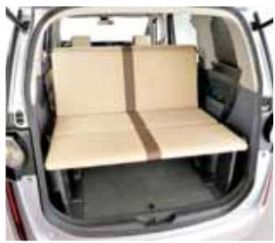
かさばる荷物を積む場合はボードを垂直に立て、ラゲジボードとして使用。スペースを上下2段に使えるため、効果的な積載ができる。
