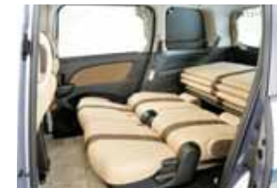
フラットフロアのボードセッティングは2列目シートをフルリクライニングさせることから始める。この上にボードを展開させてセットアップを行う。
