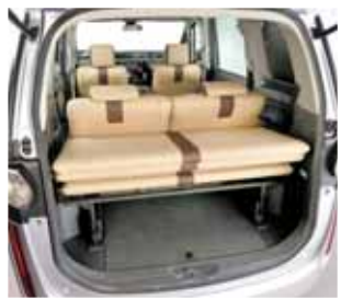
リビングモード使用時でも荷室を上下二段に使えるので十分な積載容量を確保。既存のラゲジランプは下段を、上段は増設したLEDランプで照らす。
