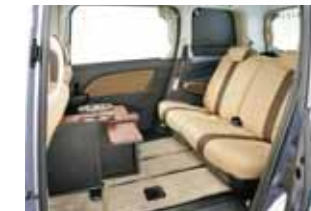
ロータスオリジナルのセンターコンソールは後方に引き出すとウイングタイプのテーブルとして、さらに引き出すとリビングモードでも使える便利な構造。
